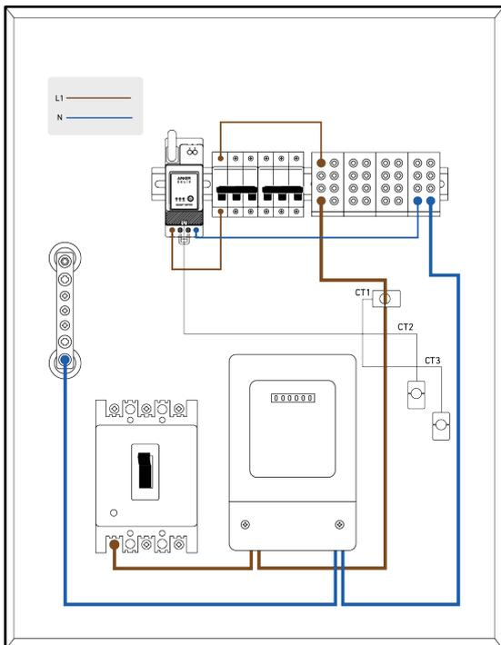
1. Commencez par identifier les phases d'entrée. Dans des circonstances normales, la phase brune est le fil de phase L1 et la phase bleue est le fil neutre N.
