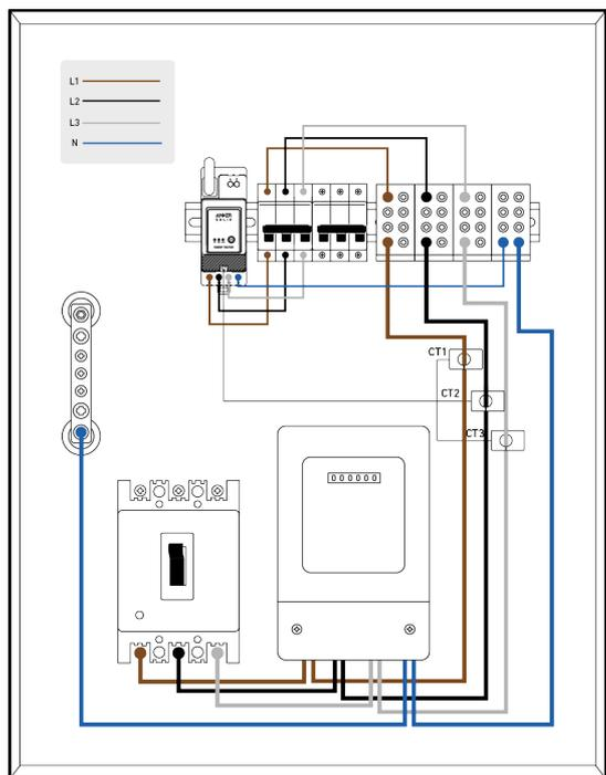
1. Commencez par identifier les phases d'entrée. Dans des circonstances normales, la phase brune correspond au fil sous tension L1, la phase noire au fil sous tension L2, la phase grise au fil sous tension L3 et la phase bleue, au fil neutre N.
